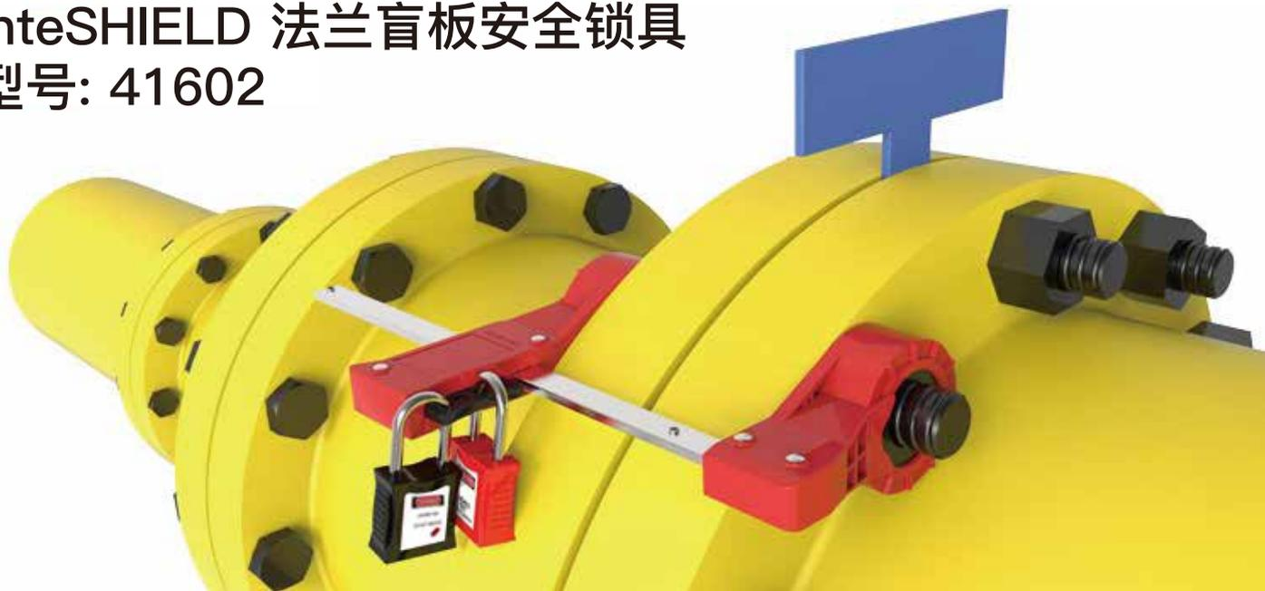
InteSHIELD 41602法兰盲板安全锁具是Patron的创新产品，通过插入空白位置来阻止流量，以解决管道阀门常规隔离的风险。InteSHIELD 41602法兰盲板安全锁具能锁定固定螺栓，以防止意外拆卸，进而可能导致重大伤害，减低环境污染。
